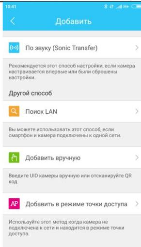
Выбираем пункт "По звуку" если подключаемся по Wi-Fi По "Lan" и "Добавить вручную" - по кабелю
