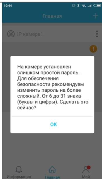
При первом подключении камеры, система попросит Вас сменить стандартный пароль "888888" на более надежный
