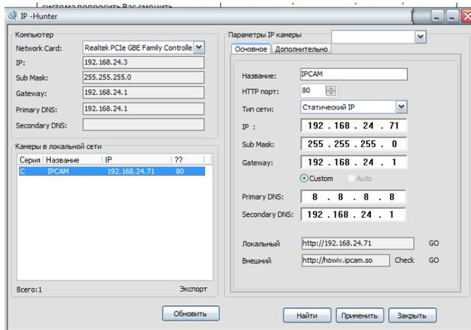
Получив IP адрес через браузер IE заходим на веб интерфейс камеры.
